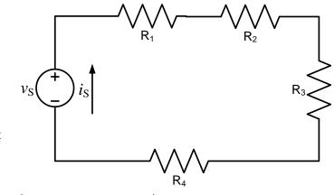
$$v_{s} = i_{s} \big( R_{1} + R_{2} + R_{3} + R_{4} \big).$$
