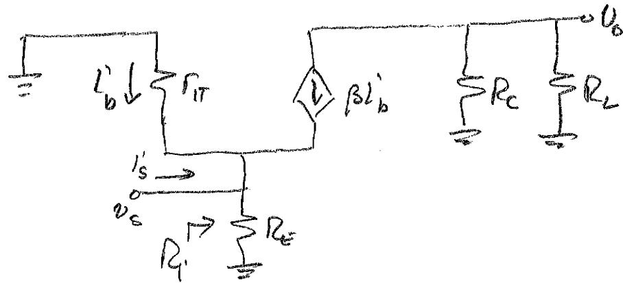
$$+8 \quad i_b' = -\frac{v_s}{R_T} \quad v_o = -\beta i_b' \cdot R_c // R_L$$
