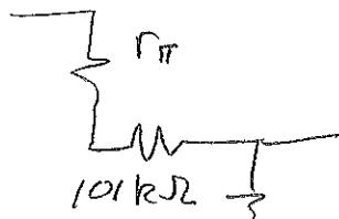
$$R'_B = 40\text{k}\Omega // 101\text{k}\Omega \approx 29\text{k}\Omega$$
