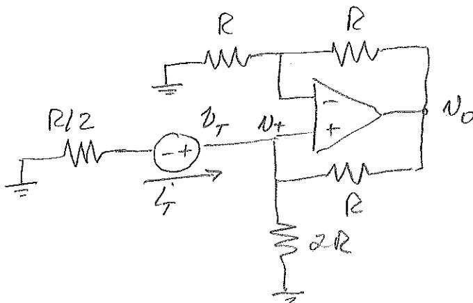
$$\text{KVL: } V_+ + \frac{R}{2} i_T' - V_T = 0$$
