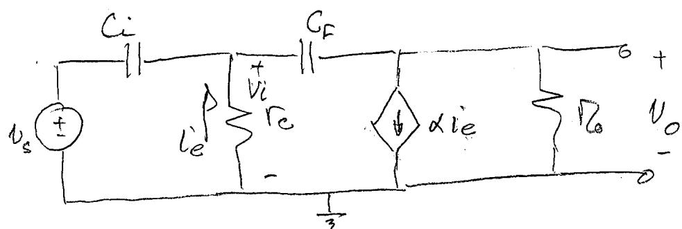
$$\frac{V_i}{R_E} + \frac{V_i - V_o}{j\omega C_F} + \frac{V_i - V_s}{j\omega C_i} = 0$$
