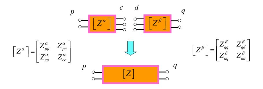
$\begin{bmatrix} V_{p} \end{bmatrix} = \begin{bmatrix} Z_{pp}^{\alpha} \end{bmatrix} \begin{bmatrix} I_{p} \end{bmatrix} + \begin{bmatrix} Z_{pc}^{\alpha} \end{bmatrix} \begin{bmatrix} I_{c} \end{bmatrix}$ (1) $\begin{bmatrix} V_{q} \end{bmatrix} = \begin{bmatrix} Z_{qq}^{\beta} \end{bmatrix} \begin{bmatrix} I_{q} \end{bmatrix} + \begin{bmatrix} Z_{qd}^{\beta} \end{bmatrix} \begin{bmatrix} I_{d} \end{bmatrix}$ (2)
