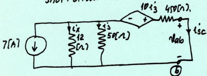
$$V_{j2} = 10i_3 = 450i_{sc} - 50i_3 \Rightarrow i_3 = \frac{45}{6}i_{sc}$$
