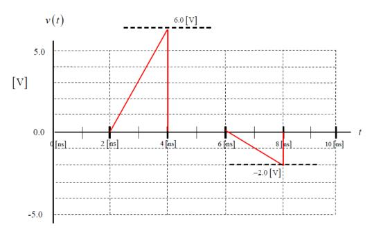
$$v(t) = \left(\frac{2}{3}\right)v_g(t-2[nS]) - \left(\frac{2}{9}\right)v_g(t-6[nS]) + \dots [V]$$
