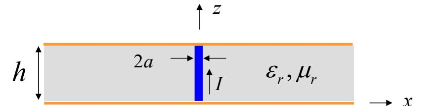
$$Z_{\text{in}} = \eta \frac{(kh)}{4} J_0(ka) H_0^{(2)}(ka)$$
